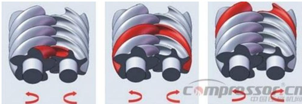
螺杆膨胀机是一种容积式膨胀机。通常所称的螺杆膨胀机指双螺杆膨胀机，开山螺杆膨胀机专门为气体的膨胀开发优化。主要由一对互相啮合的螺杆转子和机壳组成，转子与转子、转子与机壳之间以间隙密封，形成容积可连续变化的工作腔，含有热量的气态工质进入工作腔绝热膨胀，驱动转子旋转做功。膨胀做功的同时，工质的压力和温度降低，以此实现热功转换。螺杆式膨胀机进气可以是饱和蒸汽甚至带液蒸汽；螺杆之间的相对运动可以限制结垢，结垢也可以减小间隙，提高效率；螺杆膨胀机的变工况范围广，即使在较低负荷仍会有很高的等熵效率。
