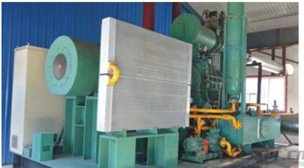
机组广泛应用于钢铁、化工行业。应用形式包括背压型、凝汽型、单级直接膨胀机组、多级直接膨胀机组以及直接膨胀机+ORC 串级机组。
